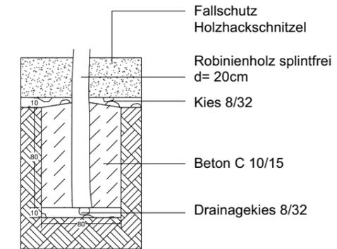
Detail 2: Betonfundament
